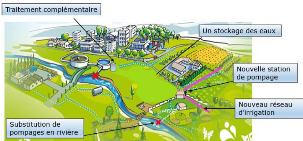
Figure 16 : schéma du projet de REUT sur la STEU de Conte, présentée par la chambre d'agriculture des Landes
