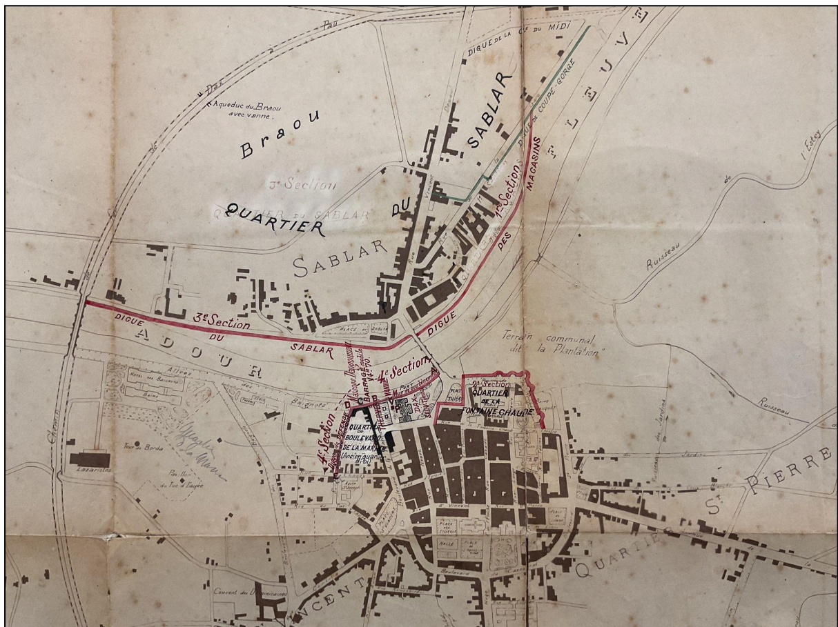
Figure 53 : Travaux de défense du quartier du sablar à Dax contre les inondations de l'Adour, 1909 [Source : AD 40, 3 S 141).
