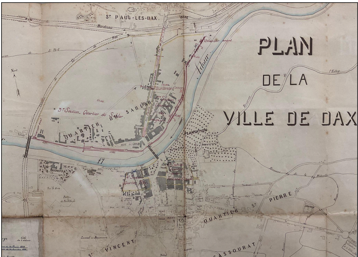
Figure 64 : Plan des digues de défense du quartier du Sablar contre les inondations, 1895 (Source : AD 40, 3 S 141).
