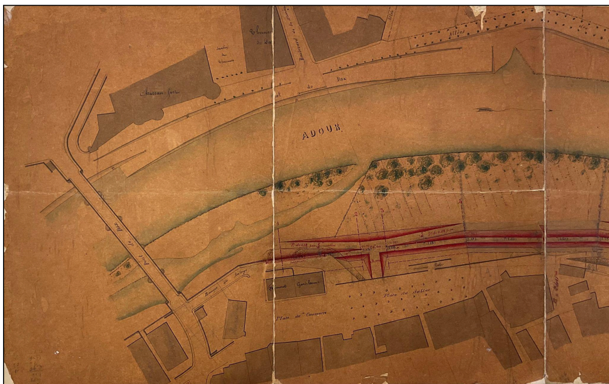
Figure 58 : Plan des travaux destinés à mettre la ville de Dax à l'abri des inondations : quartier du Sablar, 1873 (AD 40, 3 S 141).
